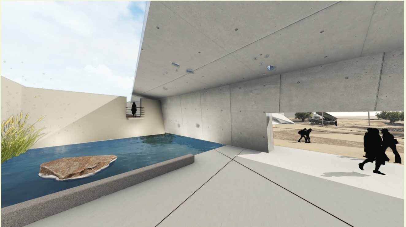
אנו משיגים לפרויקט יעילות אנרגטית גבוהה ביותר, חסכון של כ-60% מבנה יחוס, זאת בעיקר באמצעים פאסיביים, ובשילוב עם מערכות איקולוג יעילות. הפרויקט כלל מערכת מיזוג אויר בעלת יעילות גבוהה, כאשר המפזרים ממוקמים בקירות הפולרים בגובה הקהל, ומקררים את האזור עם האנשים ולא את החלל שמעלי. כמו כן, אוורור חללי התצוגה על ידי מאווררים מיוחדים – איטיים ובעלי מוטות כפפים ארוכות ( HVLS- HIGH VOLUME LOW SPEED ) המייצרים תנועת שאיבה של האווריר מהרצפה ללא הפרעה של רעש או רוח, מייצרים תחושת נוחות תרמית מקבילה לטמפרטורה הנמוכה ב-2 מעלות.
